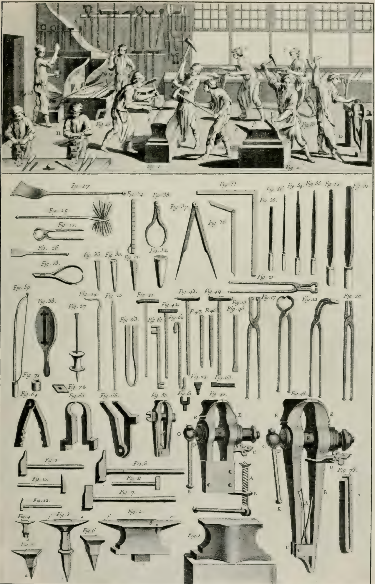
Abb. 6. Die Werkzeuge des Schlossers (Duhamel du Monceau, Art du serrurier, 1767, pl. I).
